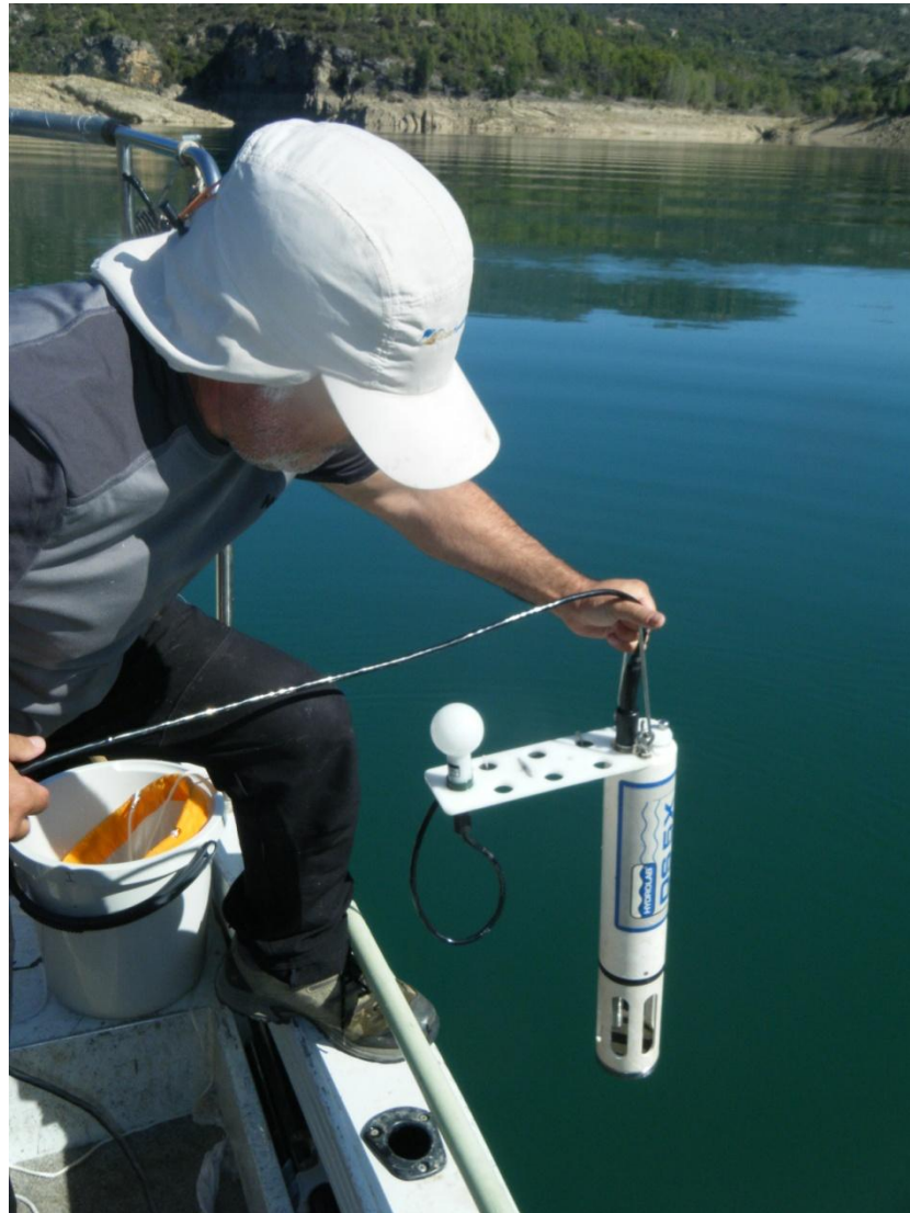
Figura 7. Perfil vertical mediante sonda multiparamétrica
