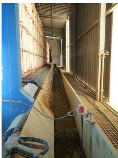
Ilustración 44: Filtro-Prensa para tratamiento de lodos
